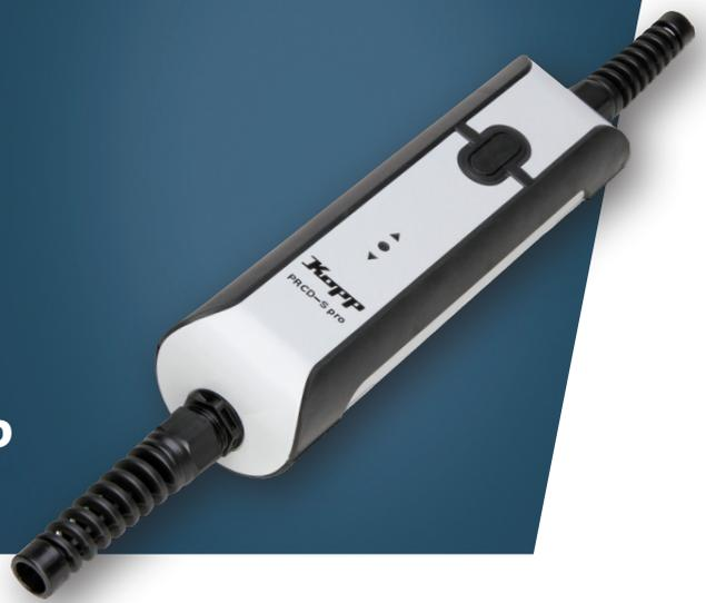
Der PRCD-S pro ist eine, als Schnurzwischengerät allpolig (L/N/PE) schaltende, ortveränderliche Differenzstromeinrichtung mit elektronischer Fehlerstromauswertung. Zusätzlich sind im PRCD-S pro Unterspannungsauslösung, Schutzleitererkennung und Schutzleiterüberwachung integriert.
